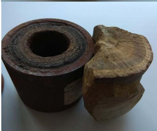
Предотвращение отложения минеральных солей и образования коррозии является одним из важнейших пунктов безаварийной работы системы. Образование отложений может служить причиной снижения пропускной способности, преждевременный износ, выход из строя теплообменного оборудования, перерасход энерго- ресурсопотребления углеводородных и газовых топливных ресурсов.
